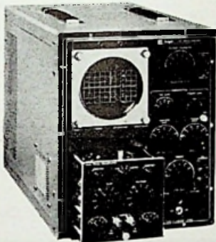
loscoop. Horizontale gevoeligheid 0,1 ... 1 V/cm, verticaal 50 mV ... 20 V/cm.
